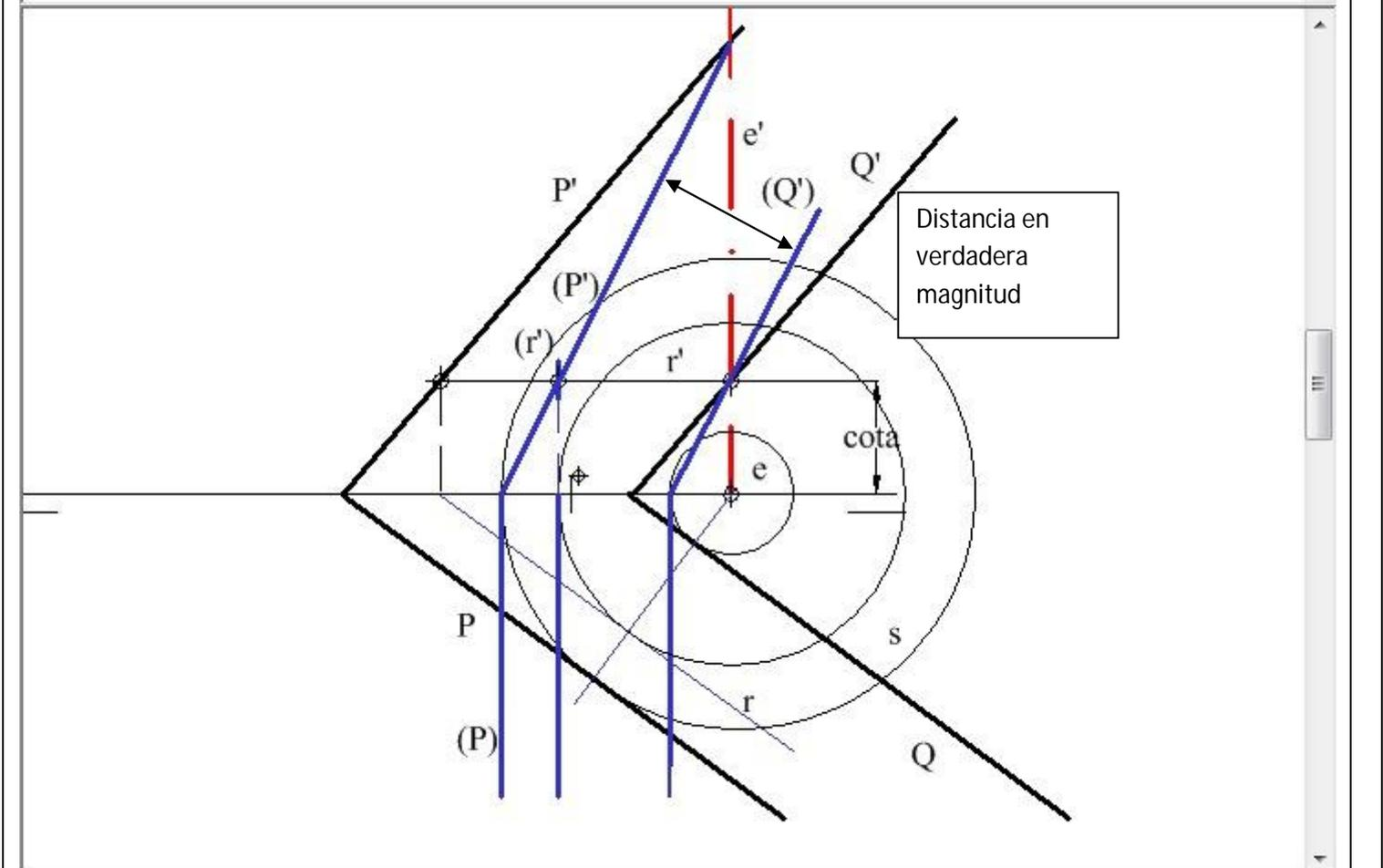
GIRO SIMPLIFICADO DE UN PLANO OBLICUO CON EJE VERTICAL CONTENIDO EN EL V.
